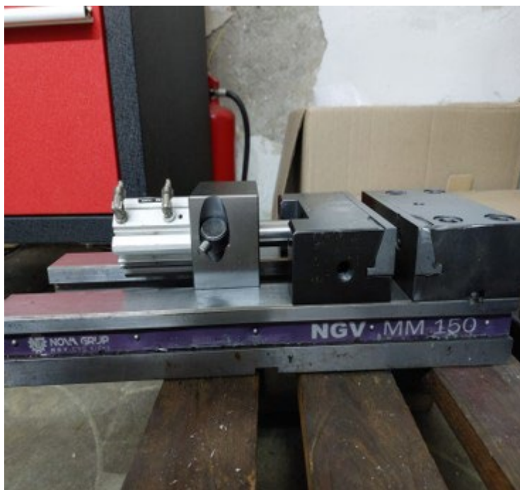
Fig. 3. Menghină NGV-MM150 echipată cu cilindru pneumatic
