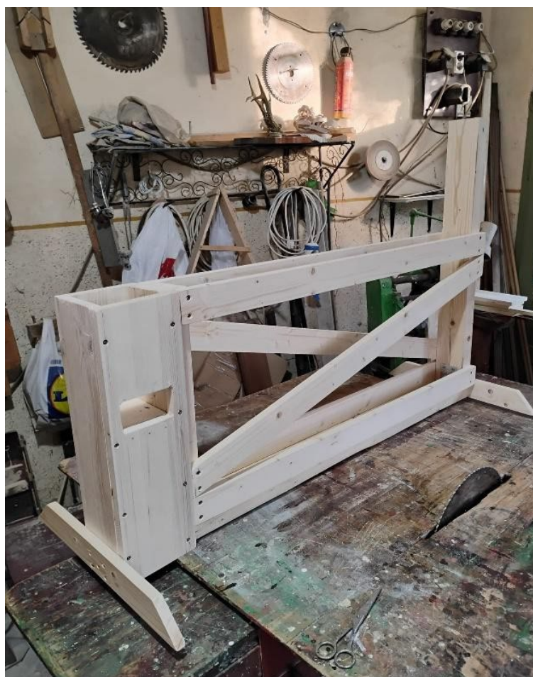
Figura 5. Adăugarea de suporturi pentru stabilitate
