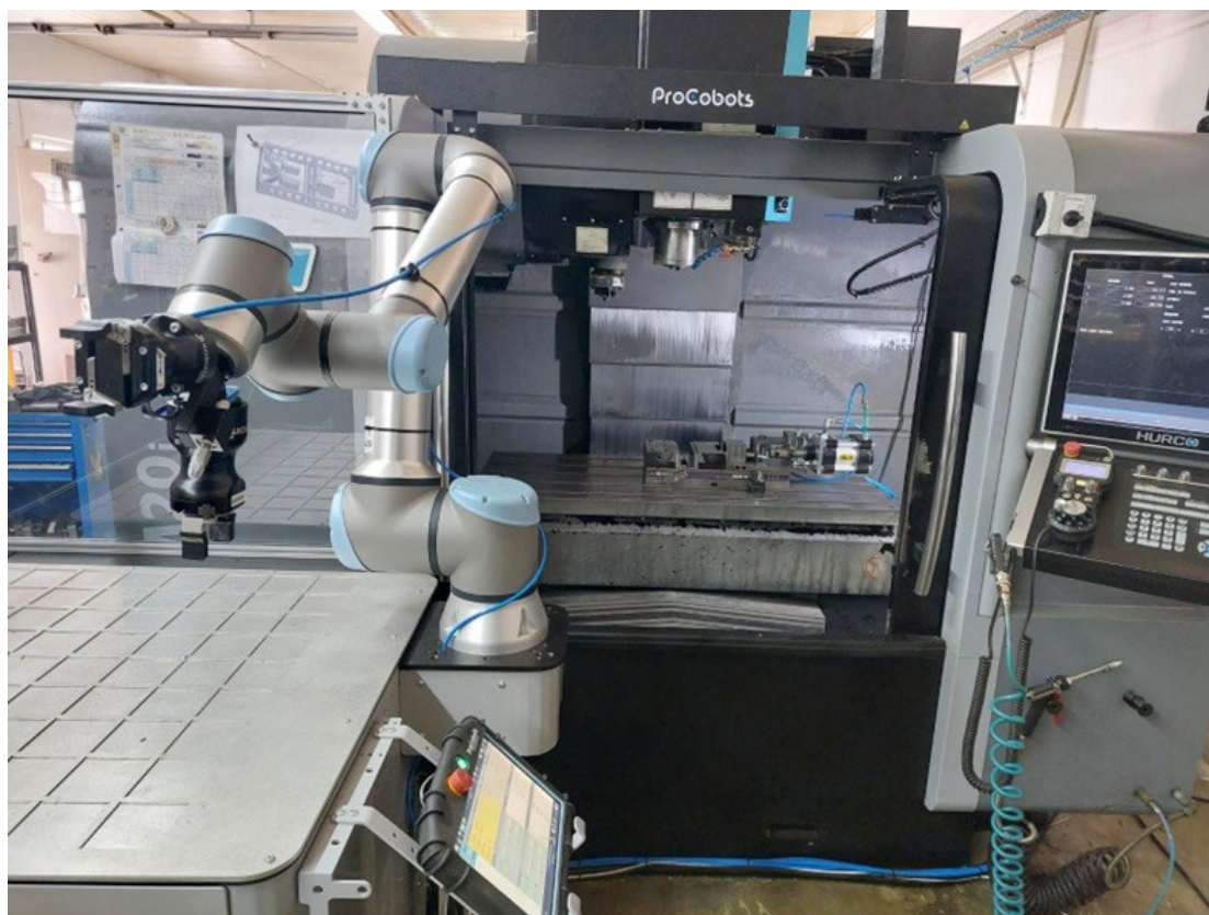
Fig. 4. Celulă robotizată de prelucrare CNC cu sistem de fixare pneumatică integrat
