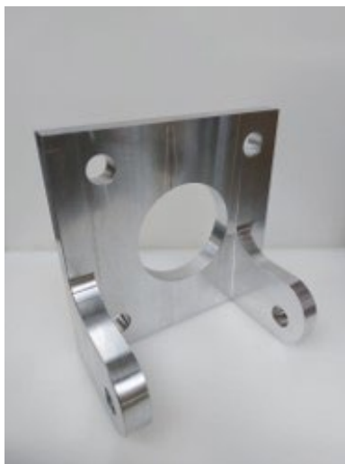
Fig. 5. Componentă prelucrată CNC utilizată în ansamblul de fixare pneumatică
